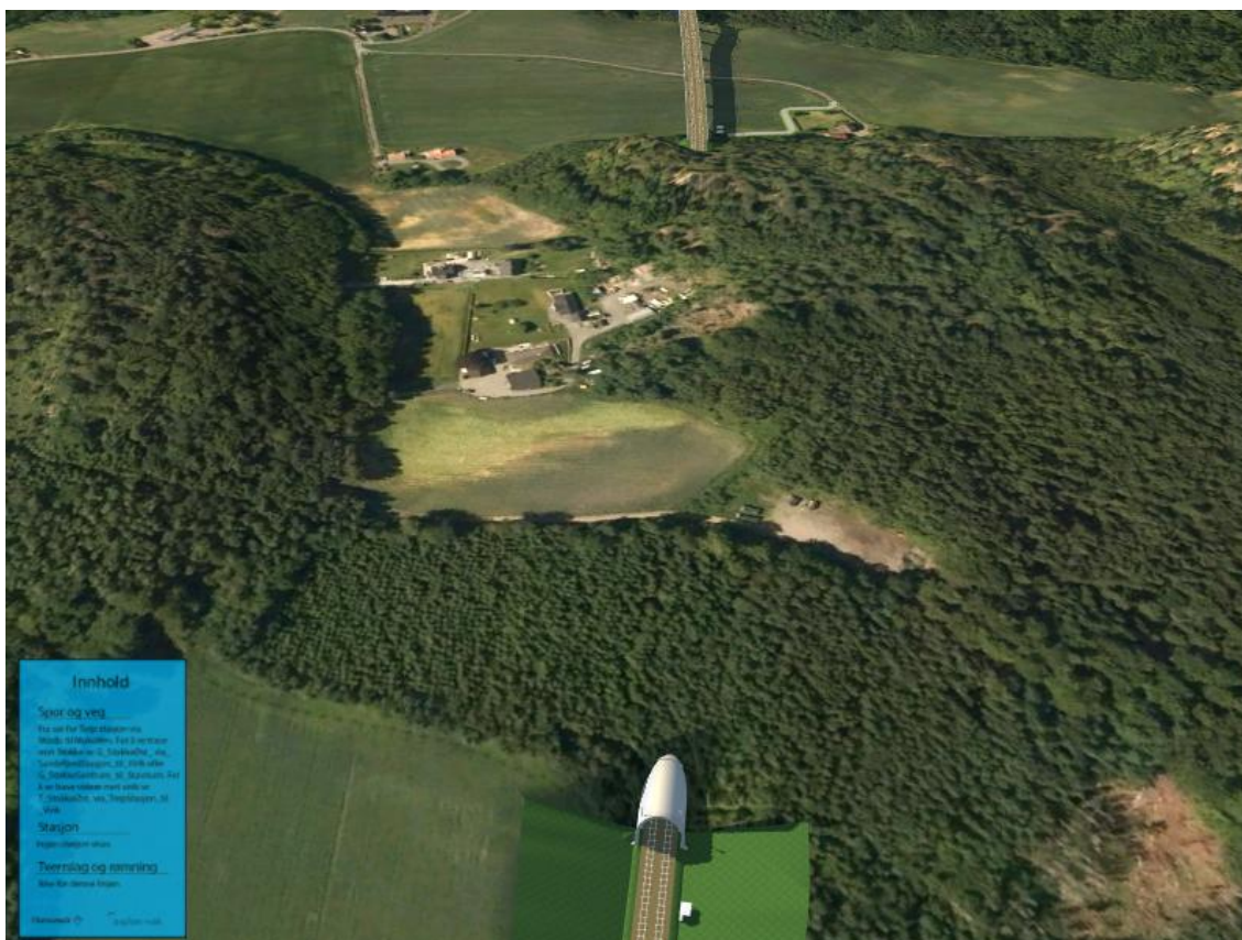
Figur 5-30: Ved Storåsen går traseen i en betongtunnel før den går over i en kort bergtunnel. Bilde fra prosjektets arbeidsmodell sett mot Sandefjord.
