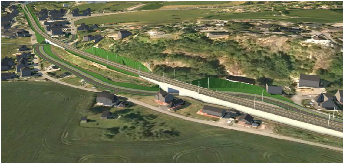
Figur 5-35: Omlegging av vegsystemet rundt fv. 270 og nytt spor lenger vest enn i dagens situasjon medfører en kraftig skjæring i Kråkås. I tillegg vil en rekke bygninger kunne berøres i traseen for ny fylkesveg. Bilde fra prosjektets arbeidsmodell. Retning Sandefjord mot venstre.
