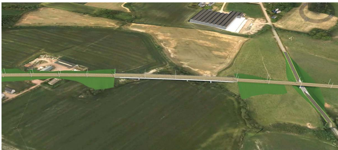
Figur 5-6: Kryssing over Vårnesbekken i bru, og senkning av Bredholtveien under jernbanen. Retning Sandefjord til venstre. Bildet er fra prosjektets arbeidsmodell.
