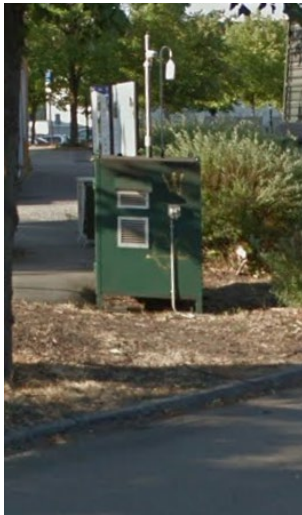
Figur 14. Målestasjon for svevestøv ved Kransen/rv. 19 i Moss. Til høyre vises skala for forurensningsklasser for PM 10 og PM 2,5 (Kilde:
